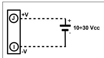
(\*) : Nota: per installazioni UL il dispositivo deve essere alimentato da una unità di alimentazione con classificazione NEC classe 2 o SELV
